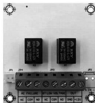
Модуль с реле мониторинга ST-PS200RB предназначен для расширения базового функционала источников питания ST-PS205E-BK. Устройство позволяет выполнять мониторинг линии 220 В и аккумуляторной батареи.
