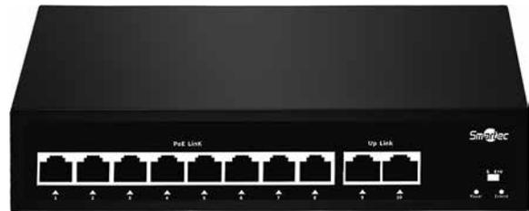
Неуправляемый экономичный коммутатор ST-NS208MB-GD предназначен для передачи данных между сетевыми устройствами, а также питания этих устройств. PoE (Power over Ethernet) – технология, позволяющая передавать удалённому устройству электрическую энергию вместе с данными через стандартную витую пару в сети Ethernet.
