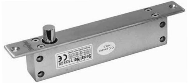
Электромеханический соленоидный замок ST-DB420MT предназначен для работы в составе систем контроля доступа с электронным управлением блокировкой дверей. Замок ST-DB420MT является нормально-закрытым, т.е. разблокируется при подаче питания и блокируется при его отключении. Для мониторинга положения створки двери в системе контроля доступа можно использовать соответствующий выход замка.
