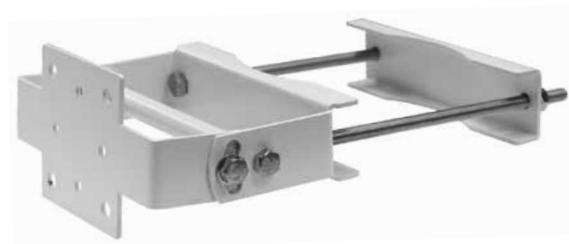
Кронштейн ST-LR300BR предназначен для монтажа УВЧ считывателей ST-LR320 и ST-LR321 на трубу диаметром до 120 мм. Устройство имеет регулировку угла наклона считывателя.
