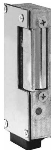
Электромеханическая защелка ST-SL651NC-L предназначена для работы в составе систем контроля доступа с электронным управлением блокировкой дверей. Она используется совместно с механическими замками с косым ригелем и врезается в дверной косяк вместо стандартной ответной части. Эта влагозащищенная модель может применяться в уличных условиях, например, на калитках, так как имеет класс защиты IP65 и высокую антикоррозийную стойкость.
