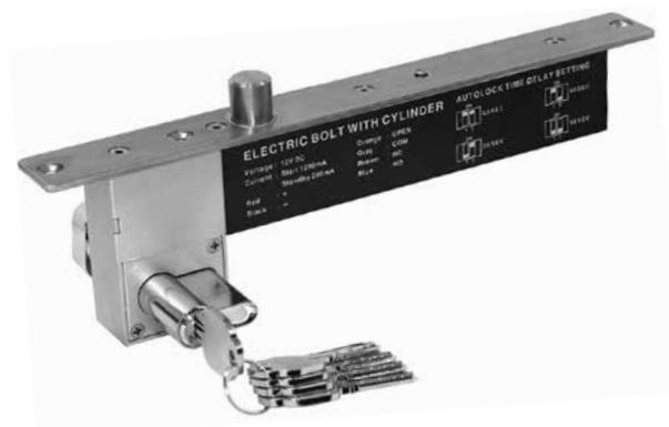
Электромеханический соленоидный замок ST-DB526MLT предназначен для работы в составе систем контроля доступа с электронным управлением блокировкой дверей. Замок ST-DB526MLT является нормально-закрытым, т.е. разблокируется при подаче питания и блокируется при отключении. Дополнительно устройство имеет возможность механической разблокировки с помощью ключа/поворотной ручки. Для мониторинга положения створки двери в системе контроля доступа можно использовать соответствующий выход замка.
