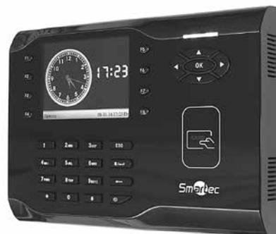
Терминал учета рабочего времени с идентификацией по проксимити картам ST-CT500EM предназначен для работы в составе СУРВ на базе программного обеспечения «Таймекс» и ведет сбор данных о приходе/уходе персонала с работы. ST-CT500EM оснащен цветным дисплеем, поддерживает до 10.000 карт и может хранить до 50.000 записей событий при автономной работе.
