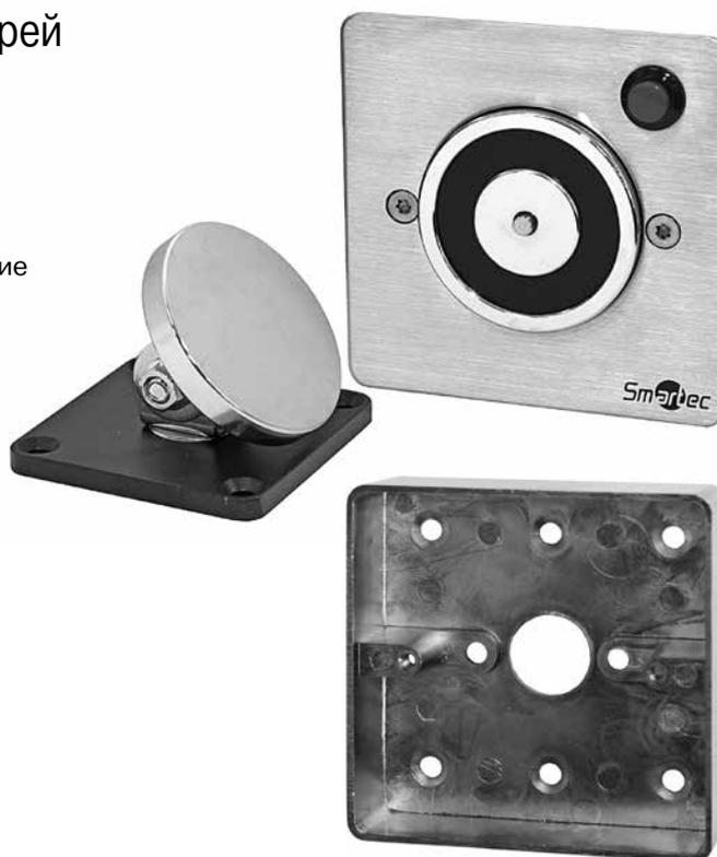
Электромагнитный фиксатор ST-DH603U предназначен для удерживания дверей в открытом положении. Устройство используется в случаях, когда необходимо обеспечить свободное перемещение людей и техники. Кроме того, электромагнитный фиксатор можно подключить к системе пожарной сигнализации, и в случае возникновения пожара на объекте устройство разблокирует удерживаемую дверь и обеспечит герметизацию зоны. Кнопка отключения фиксации может использоваться для разблокировки двери вручную.
