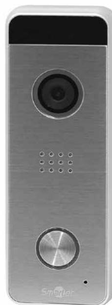
Панель вызова видеодомофонной связи ST-DS506C-SL используется для реализации односторонней видеосвязи и двухсторонней аудиосвязи с мониторами по 4-х проводной линии. Панель вызова оснащена камерой высокого разрешения и ИК подсветкой, автоматически активирующейся при снижении освещенности.
