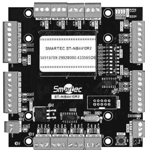
Модуль ST-NB441DR2 предназначен для увеличения емкости контроллера на 4 двери, при этом контроллер ST-NC441R2 поддерживает подключение до 15 таких модулей. 4 порта модуля предназначены для подключения любых считывателей со стандартными интерфейсами Wiegand 26, Wiegand 34 или пользовательским Wiegand 26–64.
