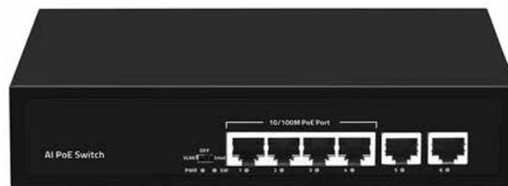
Неуправляемый коммутатор ST-NS004MB-MD предназначен для передачи данных между сетевыми устройствами, а также питания этих устройств. PoE (Power over Ethernet) – технология, позволяющая передавать удалённому устройству электрическую энергию вместе с данными через стандартную витую пару в сети Ethernet.
