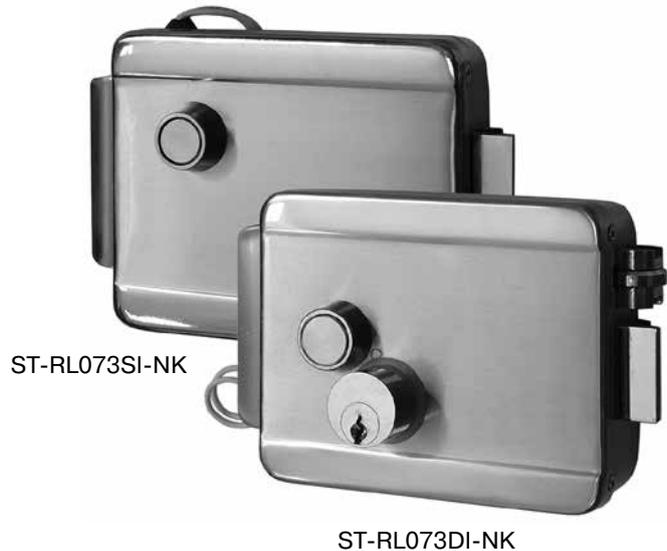
Замки ST-RL073SI-NK и ST-RL073DI-NK предназначены для запираения дверей, калиток, ворот и могут применяться совместно с системами контроля доступа (контроллеры, домофоны, кодовые панели). Управление замком осуществляется либо электрическим, либо механическим способом. Для удаленной разблокировки необходима кратковременная подача напряжения. Замок можно открыть ключом снаружи или кнопкой изнутри. Кроме того, модель ST-RL073DI-NK можно заблокировать ключом с внутренней стороны.
