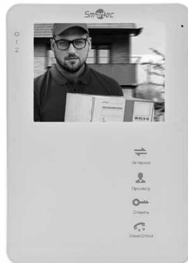
Монитор видеодомофонной связи ST-MS204M-WT используется для реализации односторонней видеосвязи и двухсторонней аудиосвязи с панелями вызова по 4-х проводной линии. Обладая широкими функциональными возможностями, этот монитор поддерживает сохранение фото и видео: при вызове с внешней панели, по срабатыванию внешних охранных датчиков или по команде пользователя. Также ST-MS204M-WT
