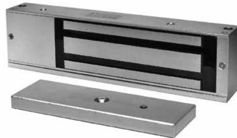
Электромагнитный замок ST-EL350ML предназначен для установки на двери, контролируемые СКУД, а также на двери эвакуационных выходов и обеспечивает удерживающее усилие 350 кг. Для преодоления остаточной намагниченности в устройстве используется специальное цинковое покрытие якоря замка совместно с пружинным механизмом, а для мониторинга степени прижима якоря к телу замка ST-EL350ML оснащен встроенным датчиком Холла.
