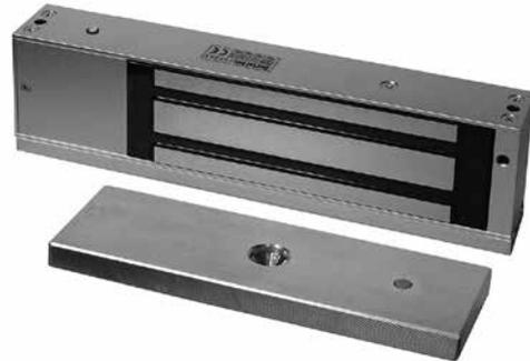
Электромагнитный замок ST-EL500ML предназначен для запираения дверей, контролируемых СКУД, и обеспечивает удерживающее усилие 500 кг. Для преодоления остаточной намагниченности в устройстве используется специальное цинковое покрытие якоря замка совместно с пружинным механизмом. Модель имеет встроенный датчик Холла для мониторинга прижима якоря к телу замка. Датчик Холла анализирует магнитный поток, т.е. силу притяжения якоря к замку, и сигнализирует о снижении усилия прижима якоря
