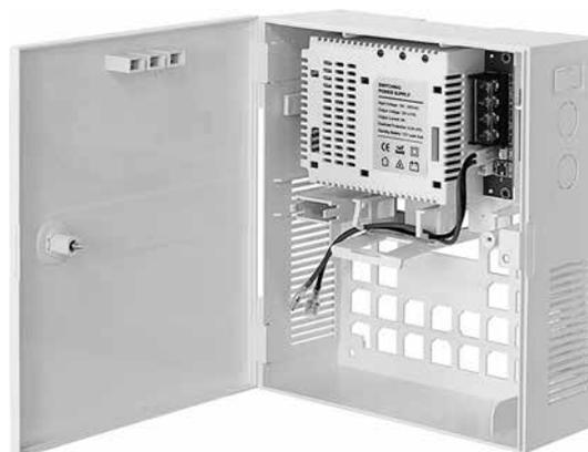
Экономичный блок бесперебойного питания ST-PS108BPS-WT предназначен для снабжения высококачественным электропитанием устройств систем контроля доступа, охранно-пожарной сигнализации, видеонаблюдения и другого оборудования с напряжением 12 В постоянного тока. Блок питания имеет световую индикацию состояния линии 220 В, линии 12 В и аккумуляторной батареи.
