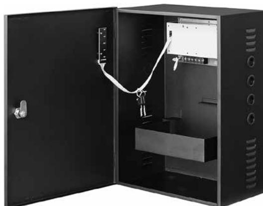
Профессиональный блок бесперебойного питания ST-PS110E-BK предназначен для снабжения высококачественным электропитанием устройств систем контроля доступа, охранно-пожарной сигнализации, видеонаблюдения и другого оборудования, работающего от источников постоянного тока с напряжением 12 В. Блок питания имеет световую индикацию состояния линии 220 В, линии 12 В и аккумуляторной батареи.
