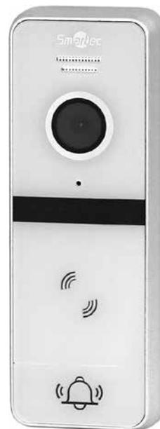
Панель вызова видеодомофонной связи ST-DS506CMF-WT используется для реализации односторонней видеосвязи и двухсторонней аудиосвязи с мониторами по 4-х проводной линии. Дополнительно панель вызова имеет встроенный автономный контроллер управления доступом со считывателем карт формата MIFARE. Устройство имеет память на 200 пользователей с идентификацией по карте.
