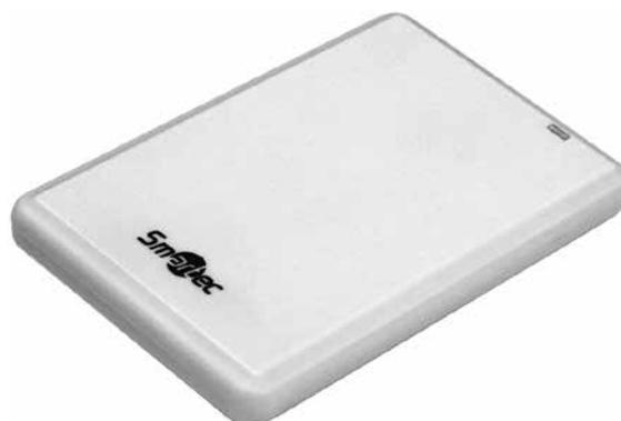
Данный USB считыватель работает с UHF картами стандарта ISO-18000-6C и ISO-18000-6B и предназначен для автоматизации ввода данных карт в различных программных приложениях. Считыватель ST-CE321LR-WT подключается к компьютеру через USB порт и определяется системой как HID-совместимое устройство. Он автоматически распознается операционной системой и не требует дополнительной установки драйверов.
