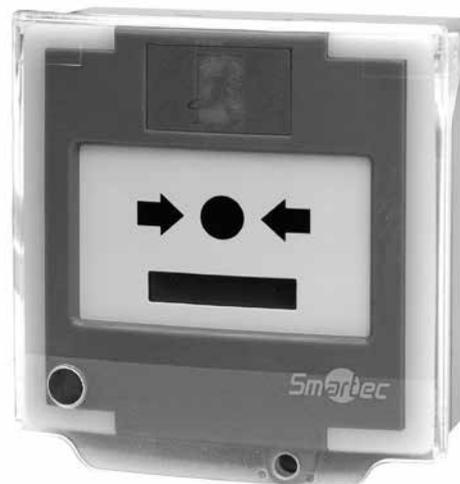
Устройство разблокировки дверей (УРД) ST-ER126DMLS-GN рекомендуется к использованию для разблокировки электрически управляемых замков в экстренных случаях с внутренней стороны на выход, например, при эвакуации людей. Восстанавливаемая кнопка активации позволяет быстро и без дополнительных расходов (замена при использовании стеклянных вставок) восстановить нормальный режим эксплуатации дверей после осуществления эвакуации.
