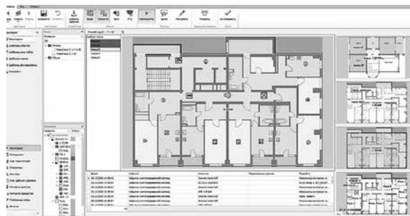
Программный модуль интеграции с системой пожарной сигнализации предназначен для централизованного мониторинга и управления пожарными панелями в рамках единой платформы «Таймекс», а также для автоматизации взаимодействия между подсистемами. На текущий момент поддерживается интеграция с панелями пожарной сигнализации Vita и Vesta.
