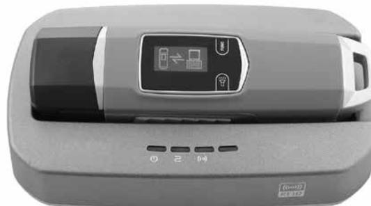
Док-станция ST-CE058EM предназначена для реализации беспроводной передачи данных между носимым терминалом контроля маршрутов ST-CT058EM и компьютером с установленным на него приложением «Таймекс». Кроме беспроводной передачи данных док-станция имеет встроенный
