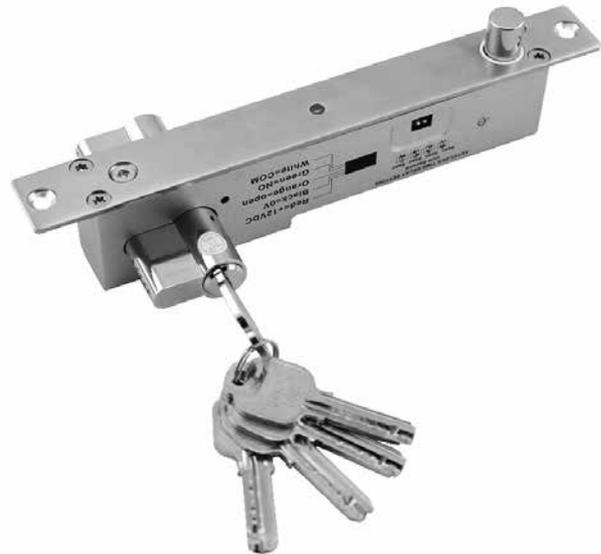
Электромеханический соленоидный замок ST-DB525MLT предназначен для работы в составе систем контроля доступа с электронным управлением блокировкой дверей. ST-DB525MLT это нормально-закрытый замок, т.е. он разблокируется при подаче питания и блокируется при отключении. Дополнительно устройство имеет возможность механической разблокировки с помощью ключа / поворотной ручки. Используя соответствующий релейный выход, в рамках СКУД можно осуществлять мониторинг положения створки двери.
