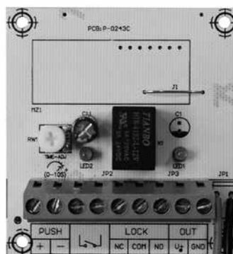
Модуль задержки ST-PS100TB предназначен для расширения базового функционала источников питания ST-PS103, ST-PS105, ST-PS103B-BK, ST-PS103C-BK, ST-PS105C-BK, ST-PS105D-BK, ST-PS110E-BK и ST-PS110F-BK. Устройство обеспечивает задержку включения линия питания.
