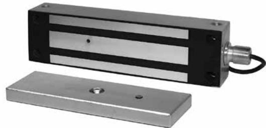
Электромагнитный замок ST-EL500MW обеспечивает удерживающее усилие, равное 500 кг, благодаря герметичному корпусу, может эксплуатироваться в уличных условиях. Его основное назначение – управляемое запираение / отпираение калиток или ворот. Данная модель имеет встроенный датчик Холла для мониторинга прижима якоря к телу замка. Датчик Холла анализирует магнитный поток, т.е. силу притяжения якоря к замку и сигнализирует о снижении усилия прижима якоря и соответственно попытке взлома. Снижение
