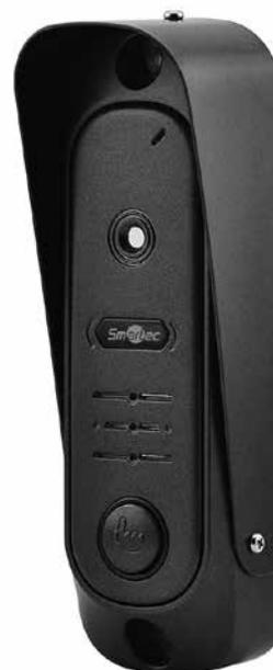
Панель вызова видеодомофонной связи ST-DS206C-BK используется для реализации односторонней видеосвязи и двухсторонней аудиосвязи с мониторами по 4-х проводной линии. Панель вызова оснащена камерой высокого разрешения и ИК подсветкой, автоматически активирующейся при снижении освещенности.
