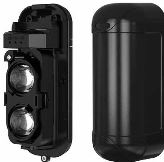
Экономичный активный уличный инфракрасный извещатель ST-PD062BDE-MS предназначен для обнаружения пересечения невидимого глазом ИК барьера значительной протяженности, создаваемого между передатчиком и приемником. Устройство может использоваться для защиты внешних и внутренних рубежей и отлично подходит для охраны объектов, периметр которых имеет значительную протяженность.
