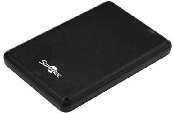
Считыватель ST-CE011MF может использоваться для ввода номеров карт MIFARE в различных программных приложениях. Данное устройство подключается к компьютеру через USB порт и определяется системой как HID-совместимое устройство. Он автоматически распознается операционной системой и не требует дополнительной установки драйверов.
