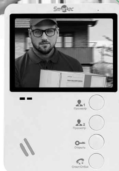
Монитор видеодомофонной связи ST-MS104-WT используется для реализации односторонней видеосвязи и двухсторонней аудиосвязи с панелями вызова по 4-х проводной линии. Этот монитор является простейшим устройством и поддерживает только
