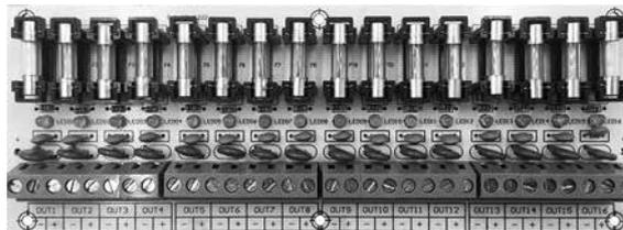
Релейный модуль мониторинга на 16 выходных каналов ST-PS116FB предназначен для расширения базового функционала источника питания ST-PS110E-BK и ST-PS110F-BK. Устройство позволяет получить 16 выходных каналов, каждый из которых защищен отдельным предохранителем.
