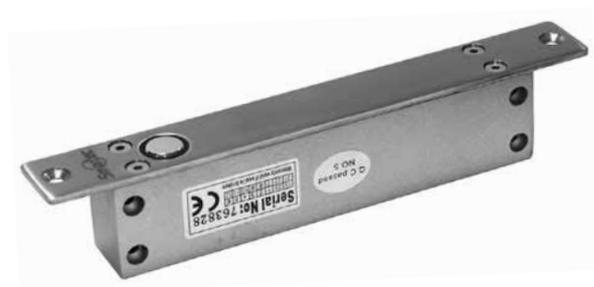
Электромеханический соленоидный замок ST-DB410MT предназначен для работы в составе систем контроля доступа с электронным управлением блокировкой дверей. Замок ST-DB410MT является нормально-открытым, т.е. разблокируются при отключении питания и блокируются при его наличии. Для мониторинга положения створки двери в системе контроля доступа можно использовать соответствующий выход замка.
