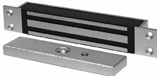
Электромагнитный замок ST-EL181S предназначен для установки на двери, контролируемые СКУД, а также на эвакуационные выходы и обеспечивает удерживающее усилие 180 кг. Устройство можно использовать для распашных или раздвижных дверей, а благодаря врезному
