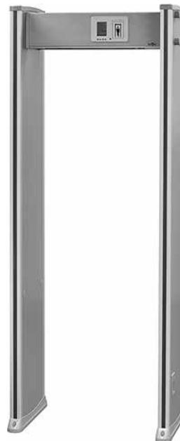
Бюджетный металлодетектор ST-MD018L предназначен для обнаружения запрещенных к проносу металлических предметов при проходе человека через арку. Устройство имеет 18 зон обнаружения, хорошую помехозащищенность, классический дизайн, всепогодное исполнение и невысокую стоимость. Чувствительность ST-MD018L регулируется в пределах, достаточных для обнаружения как оружия, так и небольших металлических предметов.
