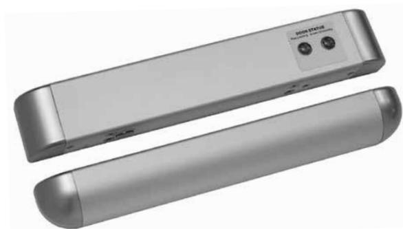
Электромеханический соленоидный замок ST-DB511MLT накладного монтажа предназначен для работы в составе систем контроля доступа с электронным управлением блокировкой дверей. Замок ST-DB511MLT является нормально-открытым, т.е. разблокируются при отключении питания и блокируются при его наличии. Для мониторинга положения створки двери в системе контроля доступа можно использовать соответствующий выход замка.
