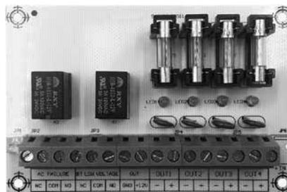
Релейный модуль мониторинга на 4 выходных канала ST-PS104FBR предназначен для расширения базового функционала источников питания ST-PS105, ST-PS105C-BK, ST-PS105D-BK, ST-PS110E-BK и ST-PS110F-BK. Устройство позволяет выполнять мониторинг состояния линии 220 В и аккумуляторной батареи, а также обеспечивает 4 выходных канала, каждый из которых защищен отдельным предохранителем.
