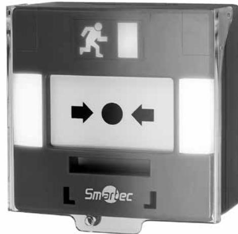
Устройство разблокировки дверей (УРД) ST-ER116TLS-GN рекомендуется к использованию для разблокировки электрически управляемых замков в экстренных случаях с внутренней стороны на выход, например, при эвакуации людей. Восстанавливаемая кнопка активации позволяет быстро и без дополнительных расходов (замена при использовании стеклянных вставок) восстановить нормальный режим эксплуатации дверей после осуществления эвакуации.
