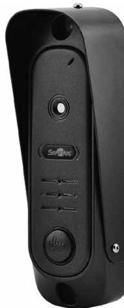
Панель вызова видеодомофонной связи высокого разрешения ST-DS201H-BK используется для реализации односторонней видеосвязи и двухсторонней аудиосвязи с мониторами по 4-х проводной линии. Панель вызова оснащена камерой высокого разрешения и ИК подсветкой, автоматически активирующейся при снижении освещенности.
