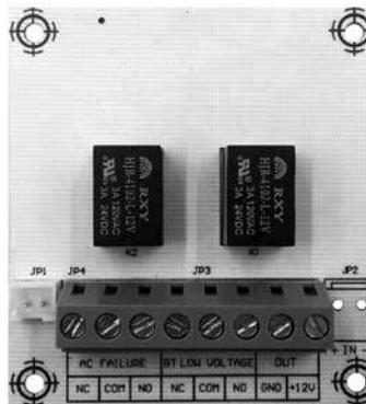
Модуль с реле мониторинга ST-PS100RB предназначен для расширения базового функционала источников питания ST-PS103, ST-PS105, ST-PS103B-BK, ST-PS103C-BK, ST-PS105C-BK, ST-PS105D-BK, ST-PS110E-BK и ST-PS110F-BK. Устройство позволяет выполнять мониторинг состояния линии 220 В и аккумуляторной батареи.
