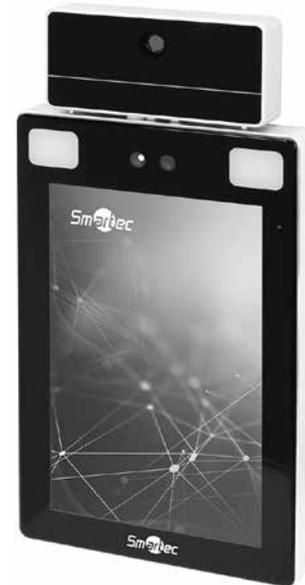
Биометрический считыватель ST-FR043T предназначен для идентификации по геометрии лица и используется в системах контроля доступа и учета рабочего времени. Устройство поддерживает следующие режимы идентификации: по геометрии лица, по ладони, по коду. Считыватель предназначен для использования в помещении в диапазоне температур от +16 до +35°C.
