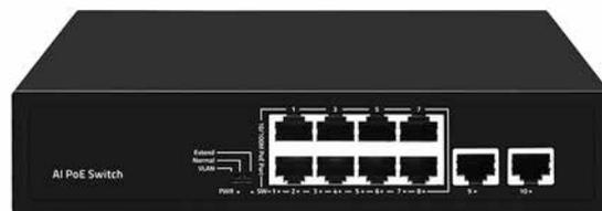
Неуправляемый коммутатор ST-NS008MB-GD предназначен для передачи данных между сетевыми устройствами, а также питания этих устройств. PoE (Power over Ethernet) – технология, позволяющая передавать удалённому устройству электрическую энергию вместе с данными через стандартную витую пару в сети Ethernet.
