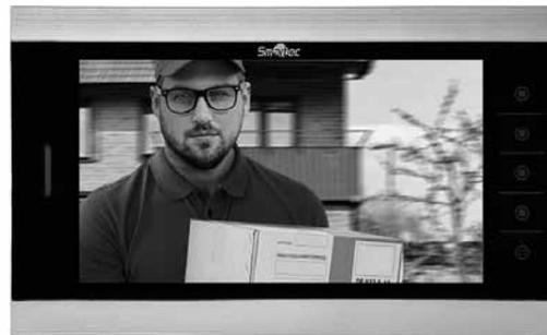
Монитор видеодомофонной связи ST-MS510M-SL используется для реализации односторонней видеосвязи и двухсторонней аудиосвязи с панелями вызова по 4-х проводной линии. Обладая широкими функциональными возможностями, этот монитор поддерживает сохранение фото и видео: при вызове с внешней панели, по срабатыванию внешних охранных датчиков или по команде пользователя.
