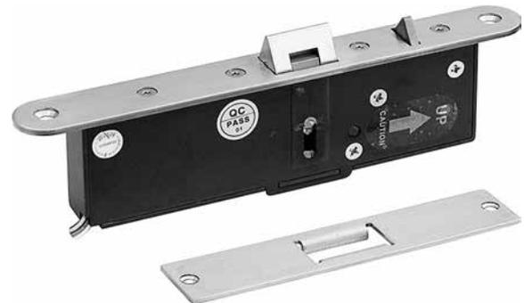
Электромеханический замок ST-DB650M предназначен для работы в составе систем контроля доступа с электронным управлением запирающим устройством двери. Замок ST-DB650M является универсальным, т.е. может работать как нормально-закрытый, так и как нормально-открытый. В нормально-закрытом режиме замок разблокируется при подаче питания и блокируется при отключении, а в нормально-открытом режиме разблокируется при отключении питания и блокируется при подаче.
