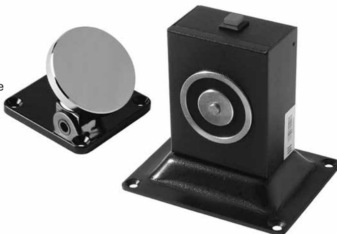
Электромагнитный фиксатор дверей ST-DH605U предназначен для удерживания дверей в открытом положении. Устройство используется в случаях, когда необходимо обеспечить свободное перемещение людей и техники. Кроме того, электромагнитный фиксатор можно подключить к системе пожарной сигнализации и в случае возникновения пожара на объекте, устройство разблокирует удерживаемую дверь и обеспечит герметизацию зоны.
