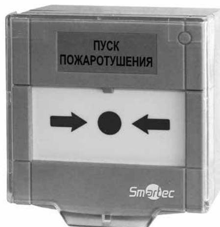
Извещатель ручной универсальный ST-ER115D-YL рекомендуется к использованию для активации или деактивации каких-либо систем и узлов. Одним из частных случаев использования является пуск пожаротушения или дымоудаления. Устройство комплектуется пластиковой восстанавливаемой вставкой, что позволяет быстро и без дополнительных расходов (замена при использовании стеклянных вставок) восстановить нормальный режим эксплуатации системы после выполнения требуемых действий.
