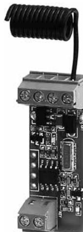
Передатчик бескорпусной на 1 канал ST-RC010TR предназначен для дистанционного управления какими-либо устройствами при совместном использовании с приемниками с динамическим кодом. Передатчик имеет входы подключения внешнего питания и кнопки управления и может встраиваться в различные устройства.
