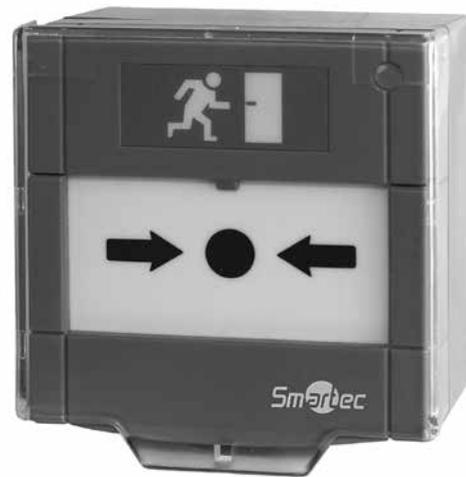
Устройство разблокировки дверей (УРД) ST-ER115SL-GN рекомендуется к использованию для разблокировки электрически управляемых замков в экстренных случаях с внутренней стороны на выход, например, при эвакуации людей. УРД комплектуется пластиковой восстанавливаемой вставкой, что позволяет быстро и без дополнительных расходов (замена при использовании стеклянных вставок) восстановить нормальный режим эксплуатации дверей после осуществления эвакуации.
