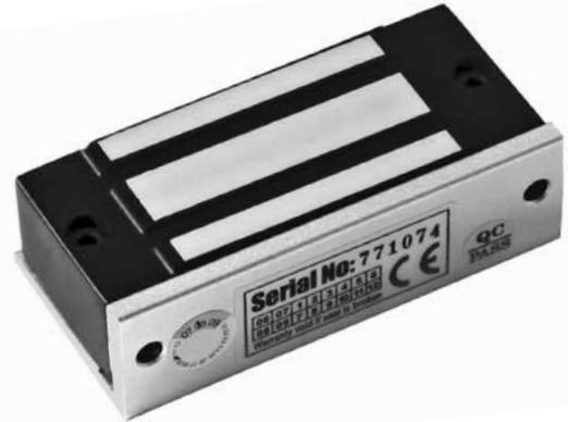
Электромагнитный замок ST-EL050S имеет силу удержания, равную 50 кг, и применяется для управляемого запираения и отпираения дверей, контролируемых системой управления доступом. Эта модель предназначена для внутреннего монтажа и может использоваться в офисах, промышленных зданиях, супермаркетах и на др. объектах с обычными требованиями к безопасности. Отсутствие в конструкции
