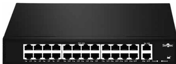
Неуправляемый экономичный коммутатор ST-NS224MB-GD предназначен для передачи данных между сетевыми устройствами, а также питания этих устройств. PoE (Power over Ethernet) – технология, позволяющая передавать удалённому устройству электрическую энергию вместе с данными через стандартную витую пару в сети Ethernet.
