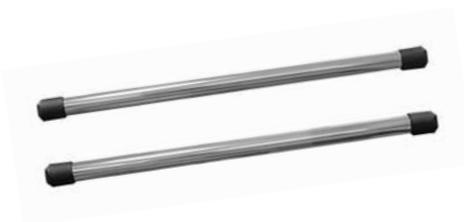
Хромированные поручни являются элементом системы ограждений, предназначенной для ограничения и направления потоков людей на объектах, оборудованных СКУД. Два поручня имеют в комплекте соединительные стаканы, предназначенные для крепления к стойкам ограждения ST-GR010P-CR, ST-GR020P-CR, ST-GR021P-CR или ST-GR030P-CR. Поручни выполнены из трубы длиной 0,5 м и диаметром 32 мм.
