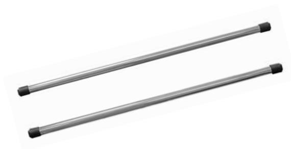
Хромированные поручни являются элементом системы ограждений, предназначенной для ограничения и направления потоков людей на объектах, оборудованных СКУД. Два поручня имеют в комплекте соединительные стаканы, предназначенные для крепления к стойкам ограждения ST-GR010P-CR, ST-GR020P-CR, ST-GR021P-CR или ST-GR030P-CR. Поручни выполнены из трубы длиной 1,5 м и диаметром 32 мм.
